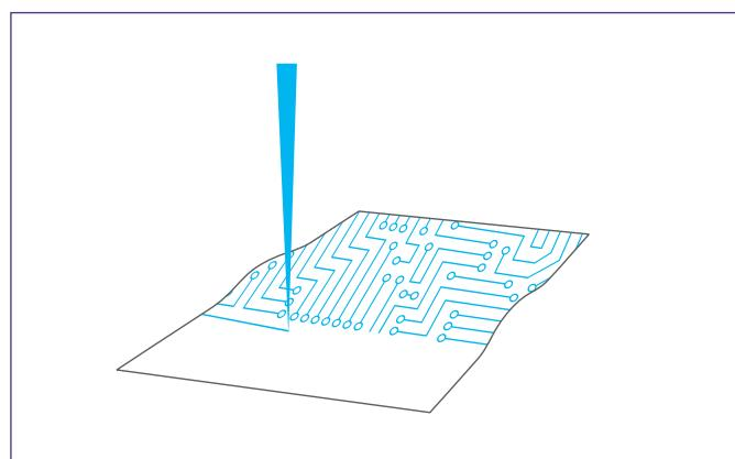
高景深 (DOF) 确保了在多种高低不均的板子上均能实现最佳的成像精度和均匀度
