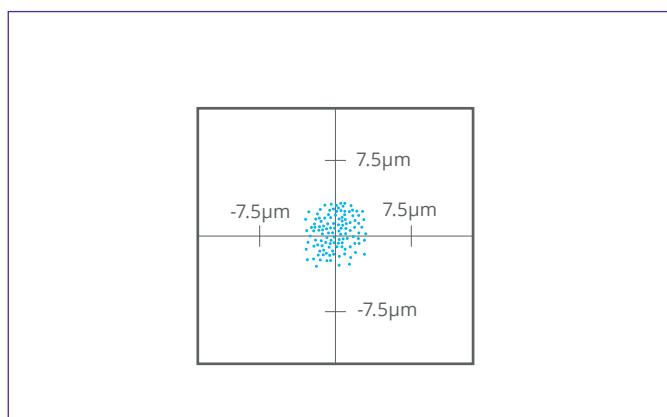
高阶应用对位精度可精确至  $\pm 7.5\mu\text{m}$
